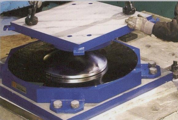
Assemblage d'un appui pendulum MAURER
