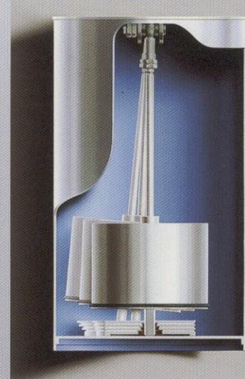
Principe actif d'un amortisseur pendulaire à frottement MAURER composé de plusieurs disques et d'un pendule, destiné à amortir les vibrations causées par le vent sur une cheminée en acier
